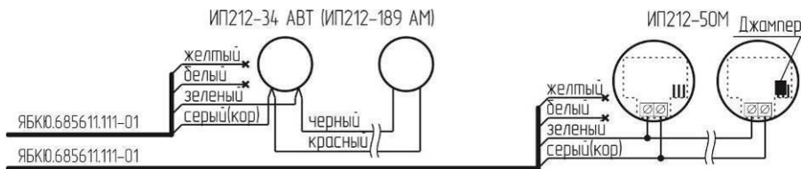
б) схема электрическая подключения пожарных извещателей
