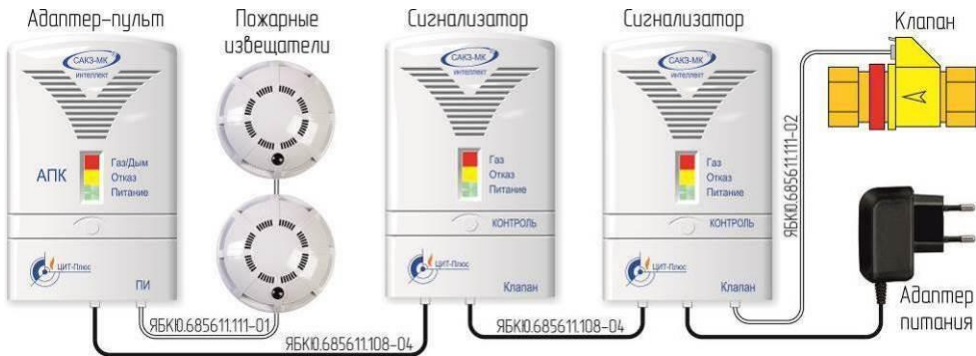
а) схема соединений. Тип клапана показан условно.
