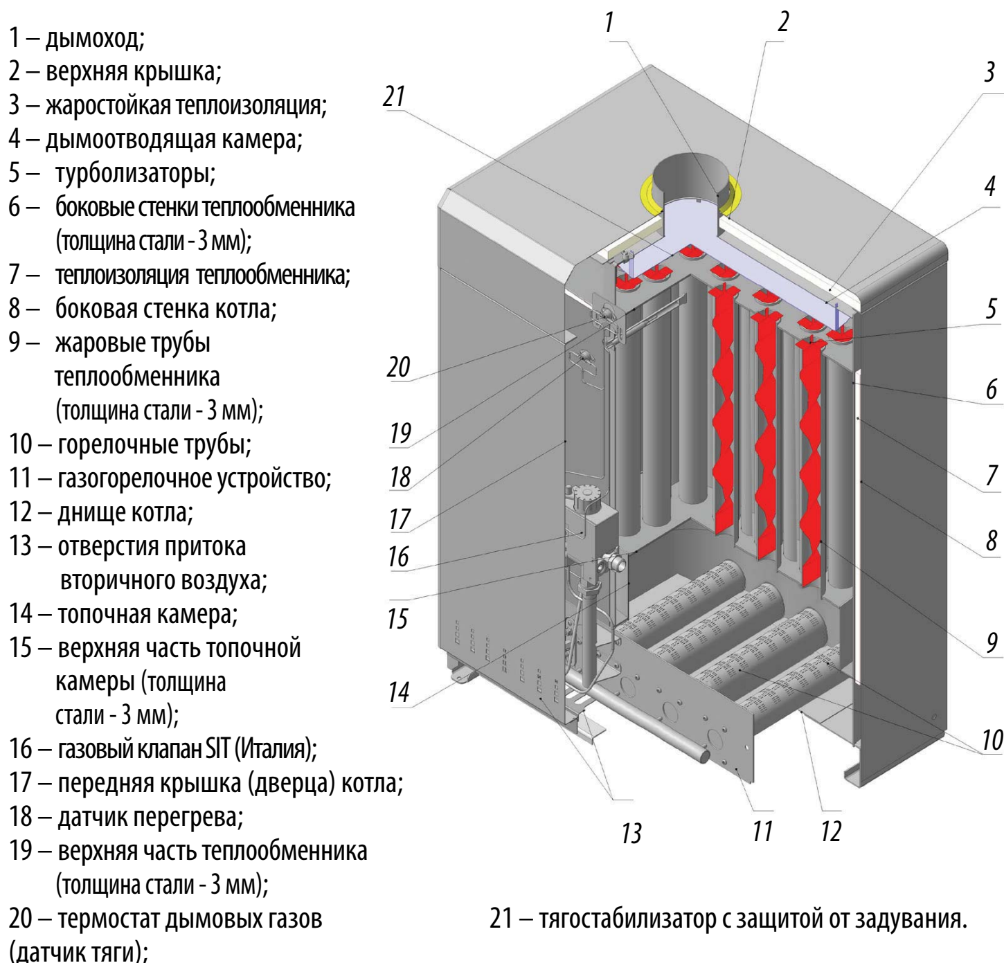
Рисунок 2 - Устройство котла КСГ
